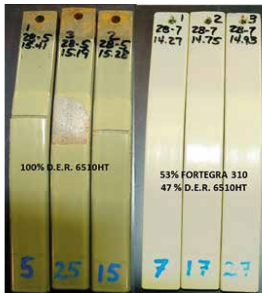
Рис. 2. Упрочненное порошковое покрытие (отвердитель дициандиамида, ОКП 10%, Tg 165 °С, 3°/PD при -32 °С)
