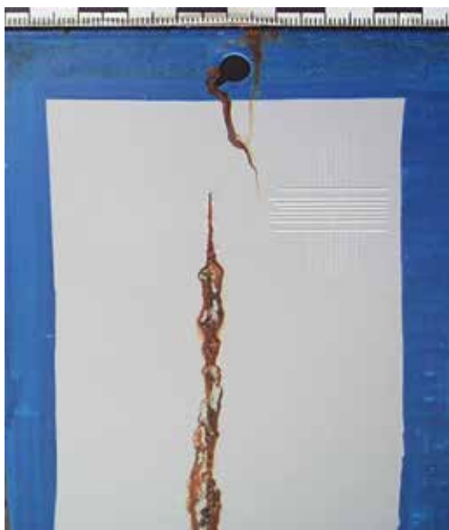
Рис. 4 Коррозионный тест (DIN 50021; камера соляного тумана)
