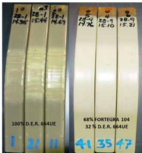
Рис. 1. Упрочненное порошковое покрытие (отвердитель дициандиамида, ОКП 20%, 3°/PD при -32 °С)
