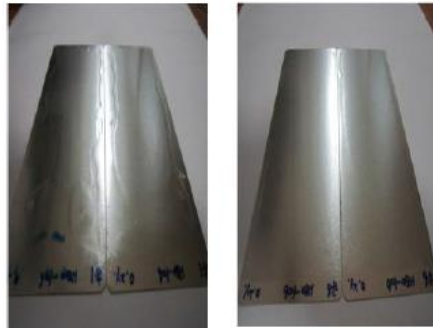
Рис. 1 Поверхность водного покрытия для дерева на основе ПУ дисперсии (PUD) с добавкой Dow Corning® 67 и без нее. Добавка вносилась в количестве 0,2% по весу по отношению к весу всего состава.
