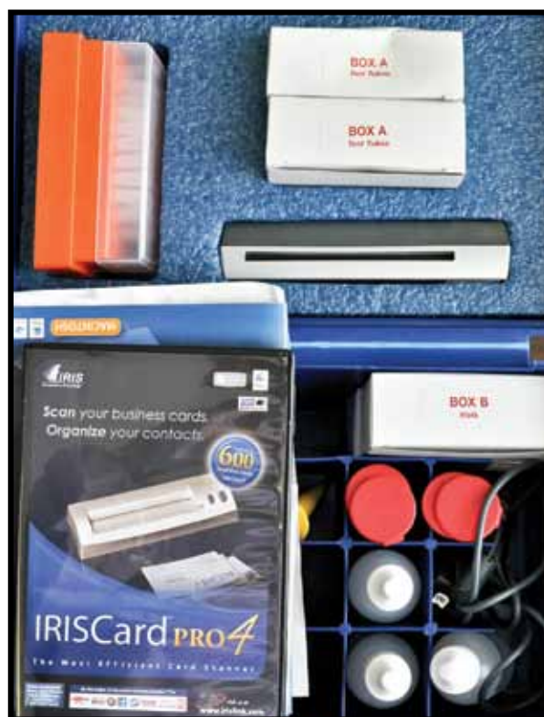
Рис. 1: Комплект для определения метки в отслеживаемом ингибиторе солеотложений ACCENT™ - тестовые полоски и сканер
